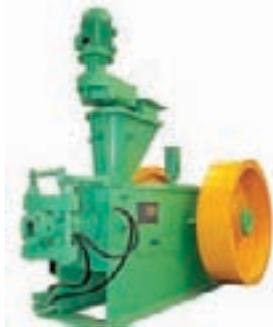
Figura 4.2 – Briquetadeira mecânica tipo biela-manivela
