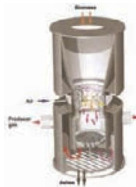
Figura 7.4 – Gasificador de extração por baixo com garganta
