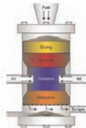
Figura 7.3 – Gasificador com extração por baixo (downdraft).
