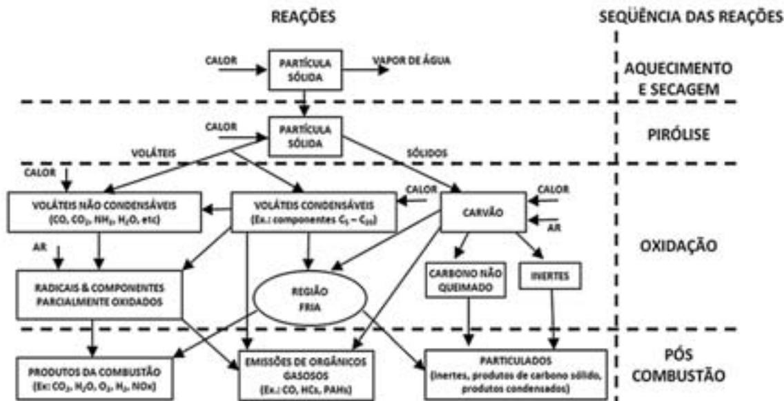
Figura 2.2 – Diagrama do processo de combustão de sólidos.
