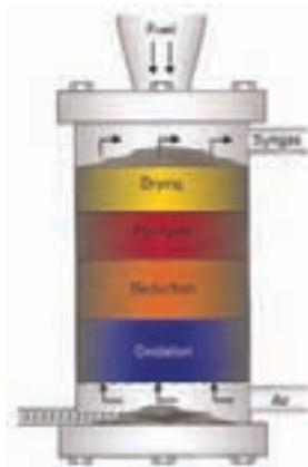
Figura 7.2 – Gasificador de extração por cima (updraft)
