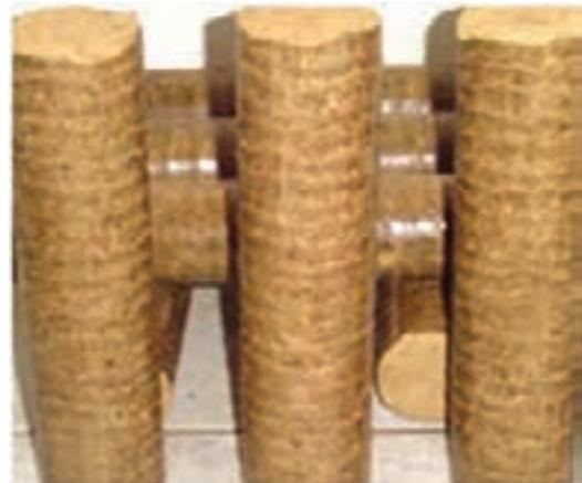
Figura 4.1 – Briquetes em forma de bolacha e em tarugos
