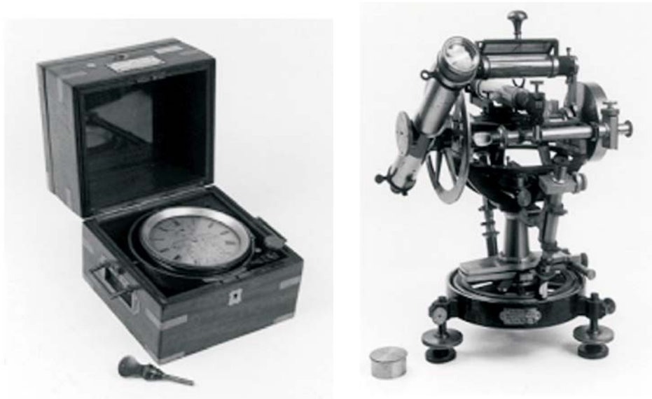
Figura 1(a e b) – instrumentos científicos procedentes do Observatório nacional, cronômetro de marinha (a) e teodolito (b).
