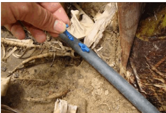
Figura 5.8 Gotejador comercial de baixo custo em sistema de irrigação localizada
