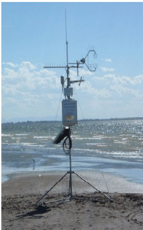
Figura 3.4 Instrumentação às margens do reservatório American Falls, Idaho, Estados Unidos, mostrando um sistema de correlação de vórtices (A) e um sistema de razão de Bowen (B)
