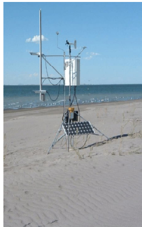
Figura 3.4 Instrumentação às margens do reservatório American Falls, Idaho, Estados Unidos, mostrando um sistema de correlação de vórtices (A) e um sistema de razão de Bowen (B)
