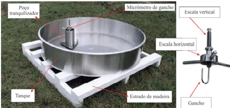
Figura 3.9 Conjunto evaporimétrico Classe A e seus componentes: poço tranquilizador com micrômetro de gancho, tanque propriamente dito e estrado de madeira. Detalhe de um micrômetro de gancho à direita
