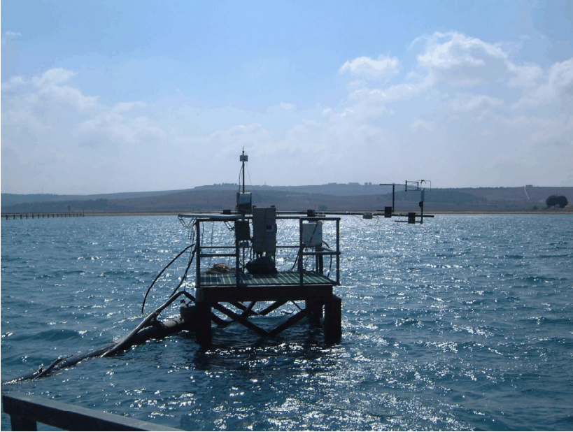
Figura 3.3 Exemplo de instrumentação micrometeorológica instalada no centro de um reservatório em Israel para estudo de evaporação da água
