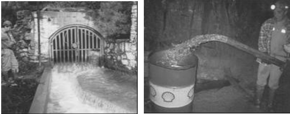
Figura 8.49 – Medições de velocidade e caudal de água subterrânea
