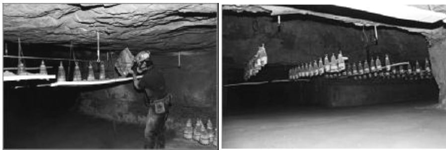
Figura 3.60 – Distribuição dos sacos de pó inerte no ambiente subterrâneo (Mina de carvão Bulli Colliery, Illawarra Region, Australia, 2002)
