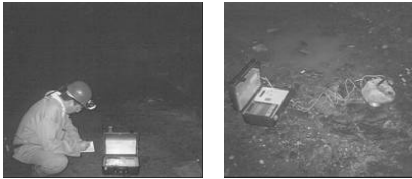
Figura 8.62 – Medições da velocidade de propagação das ondas P pela detonação de cargas explosivas com sismógrafo BlastMate II DS-277 Instantel, nos desmontes da mina da Panasqueira
