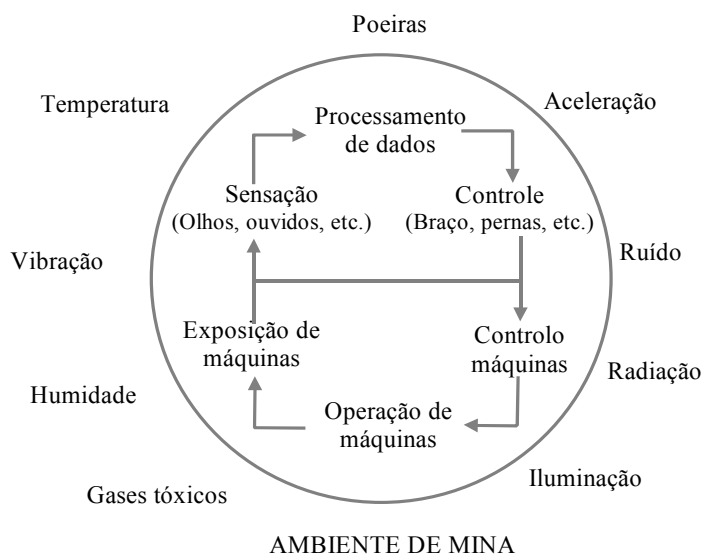
Figura 2.12 – Segurança e saúde no ambiente de operação de minas (Mutmansky, J.M., et al., 1992)
