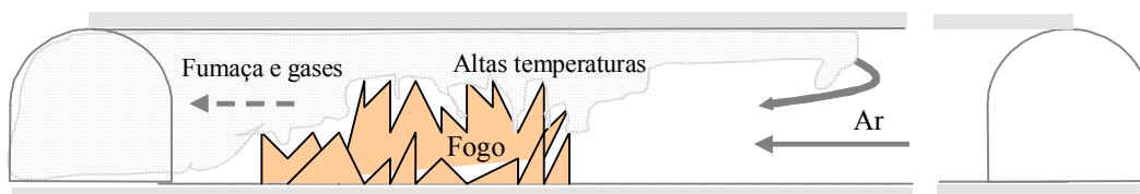
Figura 3.55 – Fogo e emanção de fumos e gases pelo incêndio em ambiente subterrâneo
