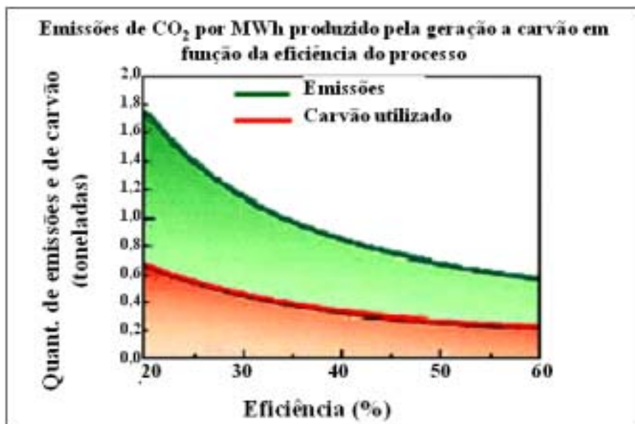
Figura 6 – Redução das emissões de CO 2 com o incremento da eficiência de combustão
