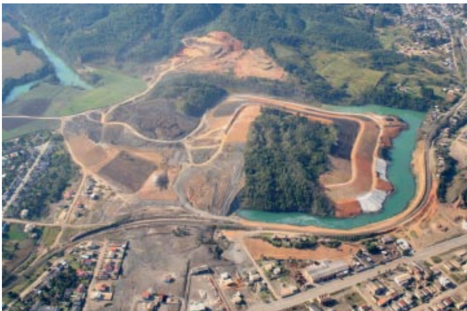
Figura 7 – Vista aérea dos trabalhos de remodelamento, cobertura com argila e de construção do novo solo (fertilização)
