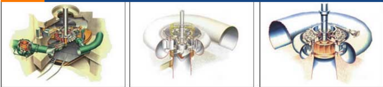
FIGURA 4.3 Exemplos de turbinas hidráulicas (Pelton, Kaplan e Francis, respectivamente).
