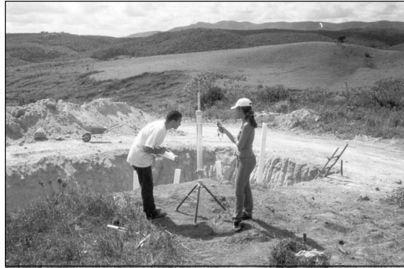
Figura 5.7 Medição da permeabilidade em campo.
