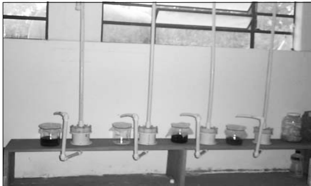
Figura A2.3 Piloto experimental: permeâmetros.
