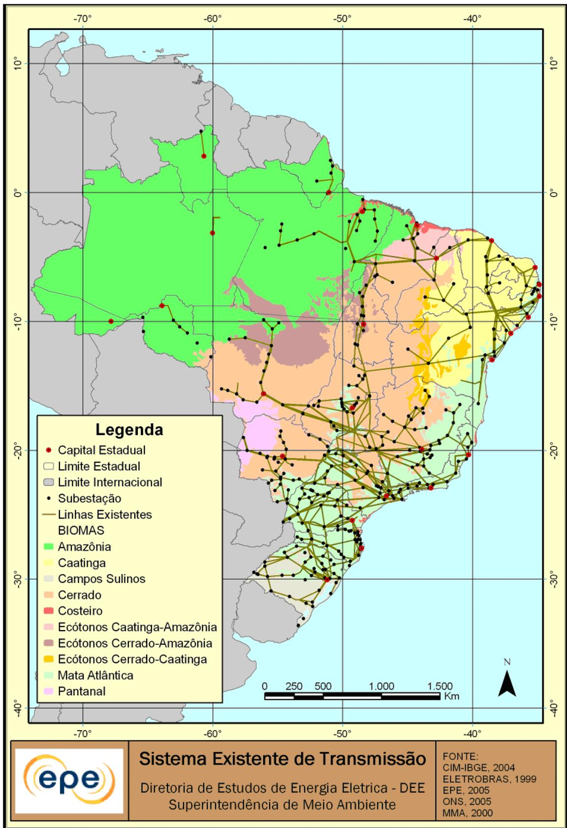
Figura 5-5 – Sistema de transmissão existente
