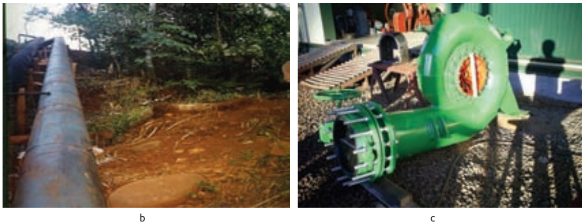
Figura 2.34 – Projeto \mu CH Novo Plano: (a) arranjo físico; (b) novo conduto forçado; (c) turbina hidráulica tipo Francis
