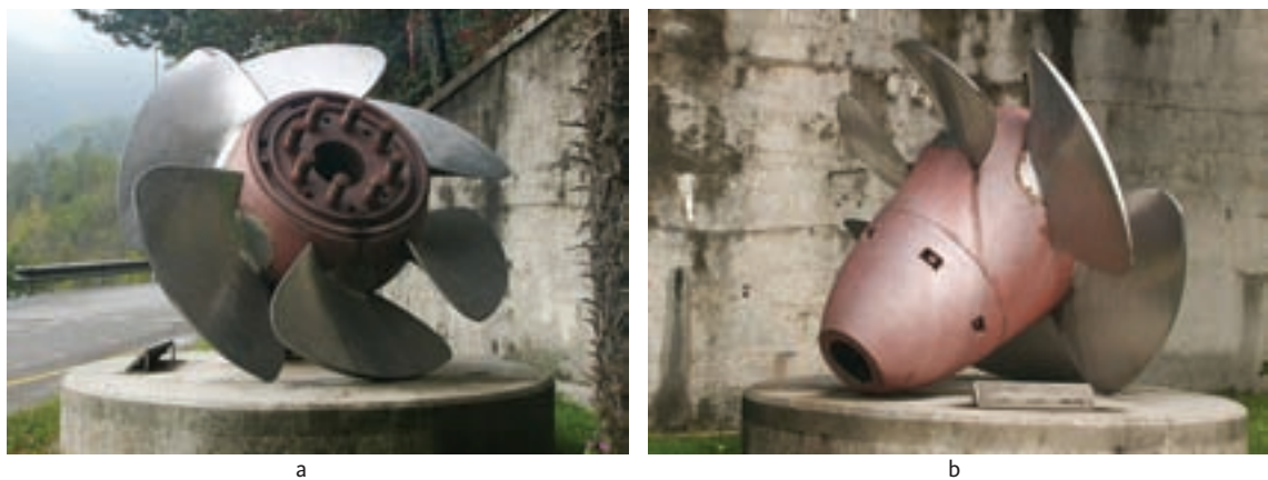
Figura 2.8 – Rotor de turbina Kaplan: (a) vista frontal; (b) vista lateral.
