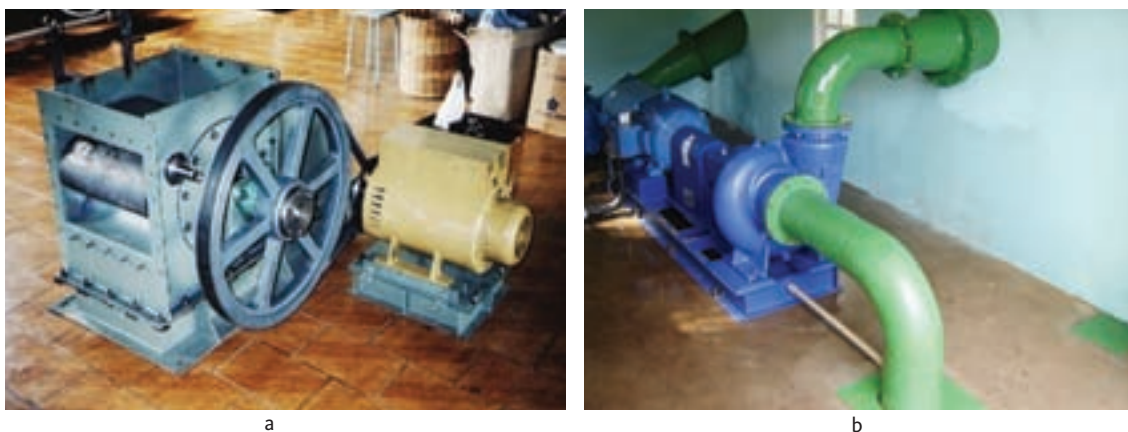
Figura 2.11 – Turbinas Hidráulicas desenvolvidas pela Unifei: (a) Michell-Banki e (b) Bomba Funcionando como Turbina – BFT
