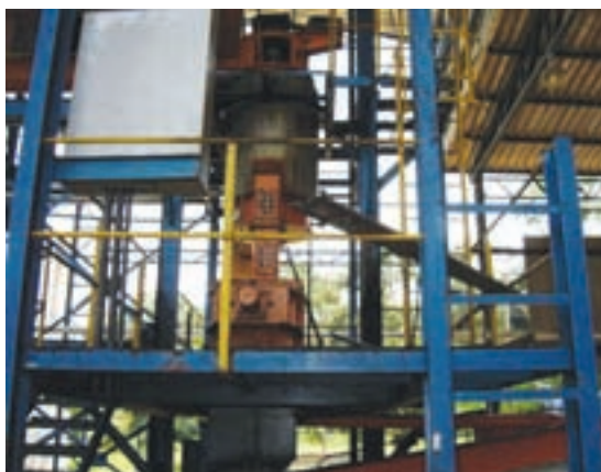
Figura 4.14 – Unidade de extração de óleo de dendê (CERU/Embrapa-CPAA)
