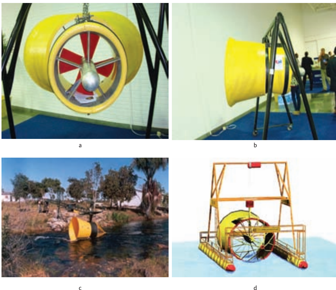
Figura 2.16 – Turbina Hidrocínética, desenvolvida pela Universidade de Brasília: (a) vista frontal; (b) vista lateral; (c) instalada num curso d'água em Correntinas; (d) montada sobre estrutura flutuante. Fonte: UnB
