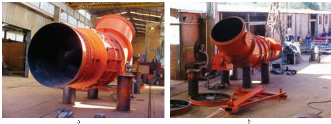
Figura 2.9 – Turbina Kaplan “S” com acoplamento do gerador: (a) e (b) Turbina “S” fabricação Haker – SC, Brasil.
